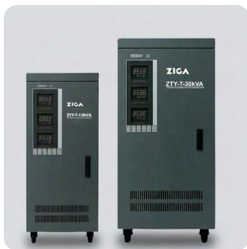
La serie de **estabilizadores ZTY-T** es esencial para sus **instalaciones**. Estos equipos constan principalmente de un autotransformador, un servomotor y un circuito de control automático. Cuando la tensión de entrada en la red fluctúa, el circuito de control envía una señal al servomotor, que ajusta la posición de la escobilla de carbón en el autotransformador. Este proceso regula la tensión de salida, manteniéndola estable y asegurando un funcionamiento confiable.
