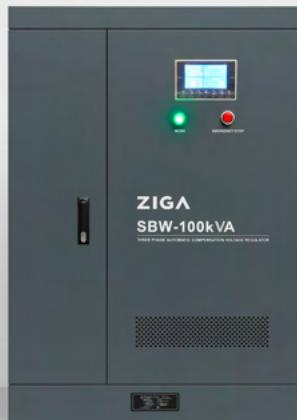
La serie de estabilizadores **ZIGA SBW** consisten principalmente en **circuitos de compensación**, detección de tensión, circuito de control servo motor y mecanismo de desaceleración de transmisión, seccionadores eléctricos y sus circuitos de operación, medida y protección de corriente y tensión. A través de estos sistemas se hace la autocompensación de tensión de salida, manteniendo una tensión estable cuando la tensión de la red fluctúa o si la carga varía.
